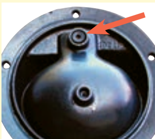
Boden des Modells 41A mit automatisch dichtendem Kugelflansch
